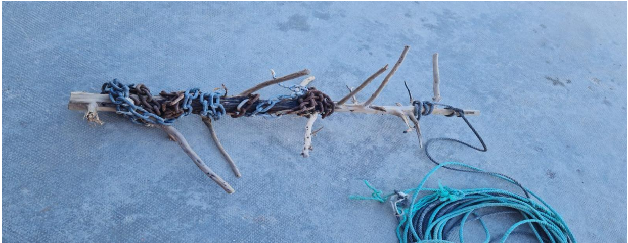
“Rampí tradicional: herramienta artesanal utilizada por los pescadores pitiusos para recuperar redes perdidas en fondos de poca profundidad.”
